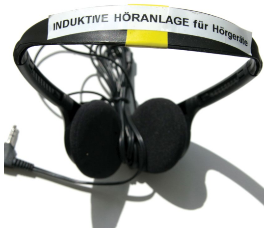
Induktiver Kopfhörer, der bei einzelnen Multimedia-Stationen in einer Ausstellung zum Einsatz kommt.
